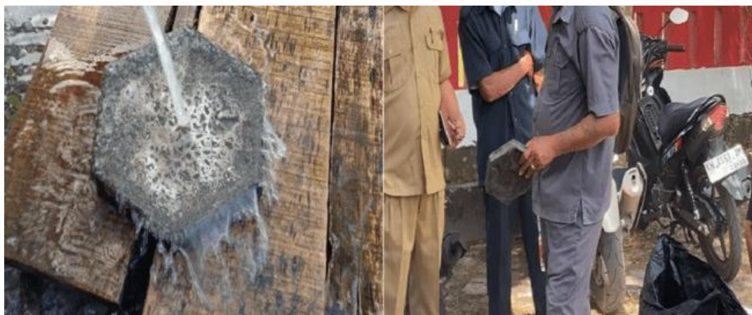
Gambar 6. Uji coba paving block: perendaman (kiri) dan pembantingan (kanan)
