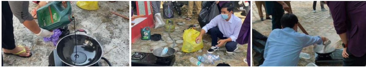
Gambar 5. Tahap 1–3 pembuatan eco paving block: pemanasan oli, pelelehan plastik, dan pencampuran pasir
